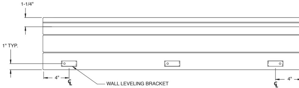
TYPICAL LEVELING BRACKET INSTALLATION (BACKVIEW)
