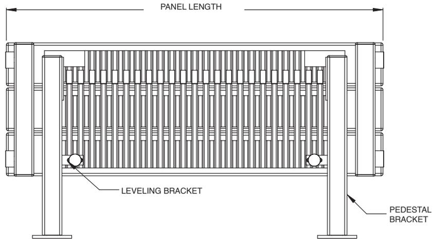
TYPICAL LEVELING BRACKET INSTALLATION (BACKVIEW)
