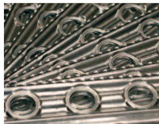
Les **ailettes** sont faites d'aluminium et formées en plaques à l'aide d'une matrice. Divers types de surfaces d'ailettes sont disponibles : sinusoidales, persiennées ou à perforations relevées afin de maximiser le transfert de chaleur avec un minimum de friction de l'air. Les matériaux en option sont le cuivre ou l'aluminium préenduit d'une matière résistante à la corrosion.
